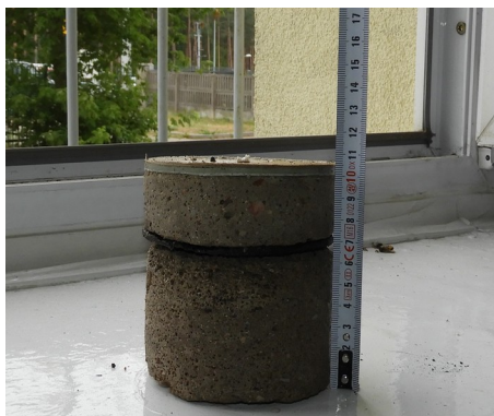
Odwiert rdzeniowy -widoczne warstwy podłogi
